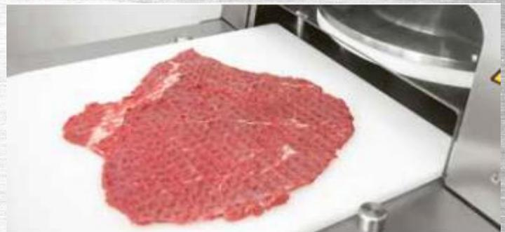
Die Fleischpresse beginnt automatisch mit dem Pressvorgang, wenn die Ablage eingeschoben wird.
